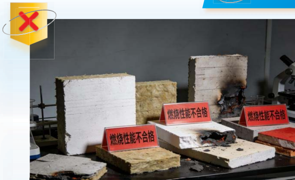
使用低于建筑防火规范和设计图纸规定的保温材料
