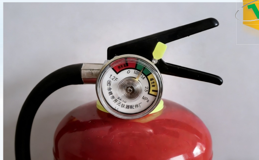
消防器材在有效期内且瓶身完好压力有效
