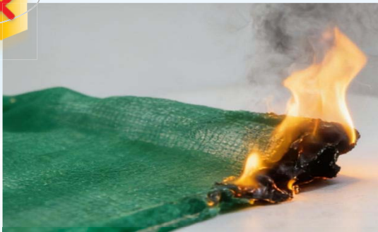
违规使用非阻燃型密目式安全网
