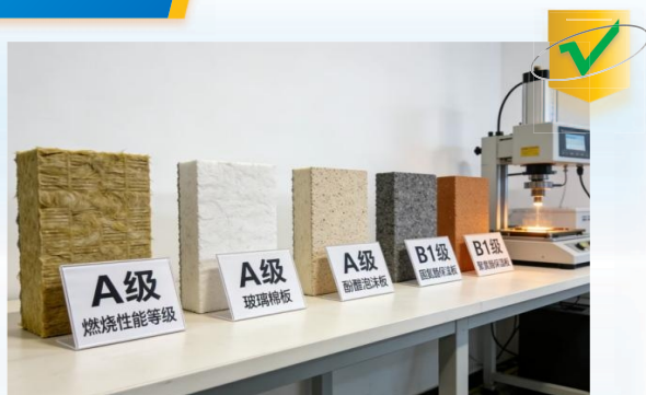
使用燃烧性能达标的保温材料
