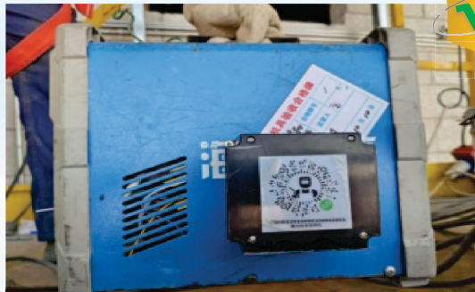
电焊设备“加芯赋码”
