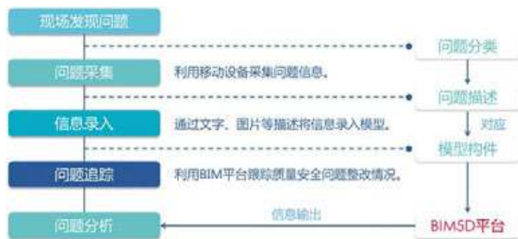
基于BIM的质量安全管理流程
