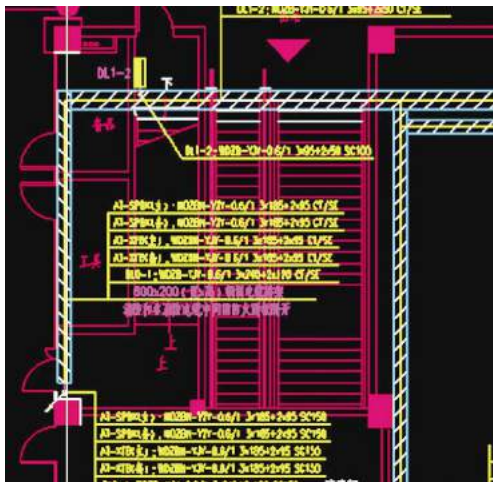
一层桥架撞楼梯,通过鲁班BIM技术提前发现了问题,并使用三维模拟改变桥架位置选择最合理的排布方案。
