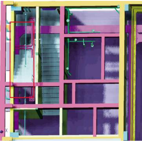
一层桥架撞楼梯,通过鲁班BIM技术提前发现了问题,并使用三维模拟改变桥架位置选择最合理的排布方案。
