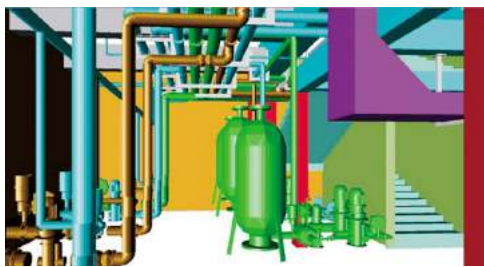
出站层消防泵撞楼梯,使用鲁班BIM技术进行三维模拟完美解决问题
