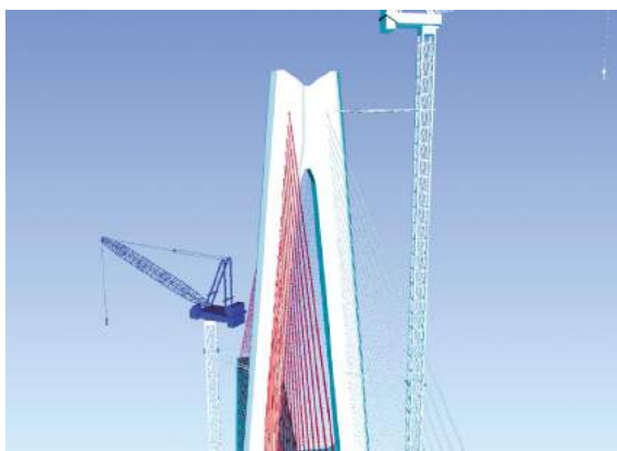
动臂塔吊拆卸过程验证
