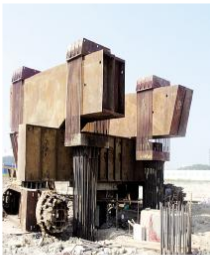
图 3.5-2 为试桩静载检测实景图
