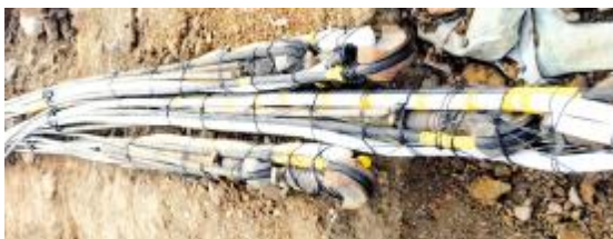
图 4: 试验二锚索加工实物图
