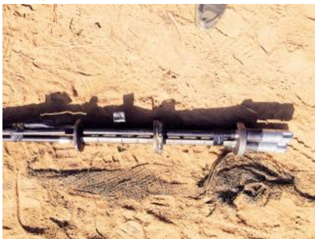
图 2: 试验一锚体结构
