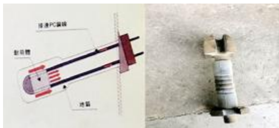
图 3: 试验二锚索结构及承载体
