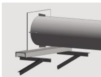
图 11 内支撑细部节点模型
