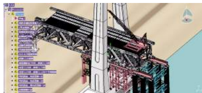
(3) 按次序拼装钢梁并分次顶推跨线
