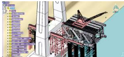
(2) 吊机行走至钢梁上并拆除临时支架
