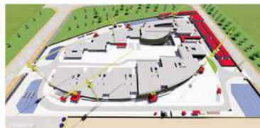
Bim 绘制上部结构场布图
