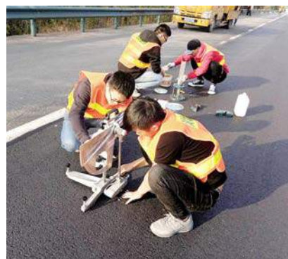
试验人员检测路面抗滑系数和渗水系数
