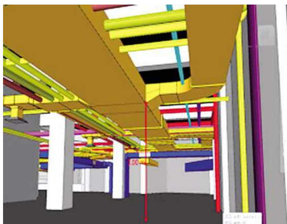
机电安装 管线综合 bim 碰撞模拟
