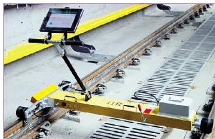
接触轨参数测量仪
