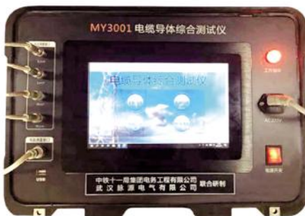
电缆导体综合测试仪
