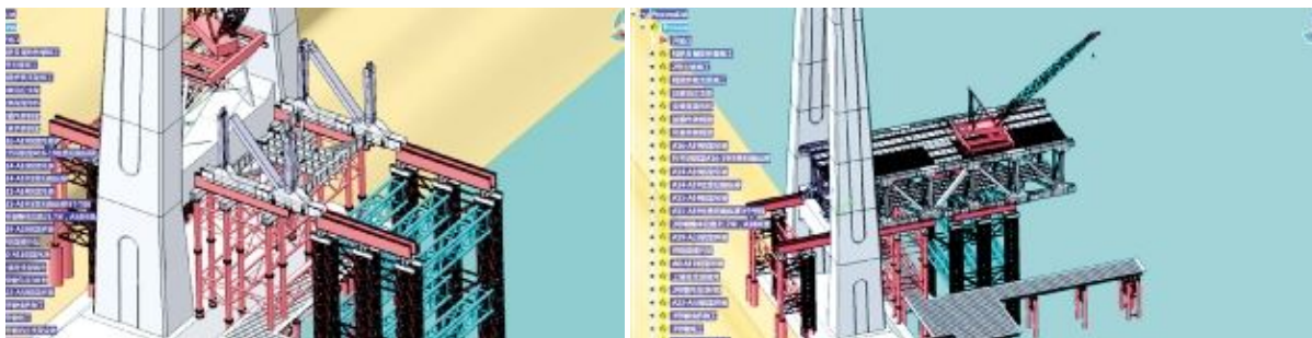
图 10 重庆侧边跨钢梁拼装与跨线顶推施工原始方案模拟
