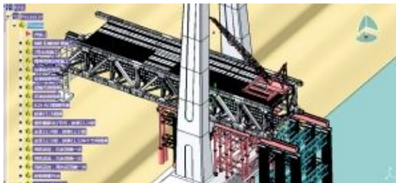
(3)按次序拼装钢梁并分次顶推跨线
