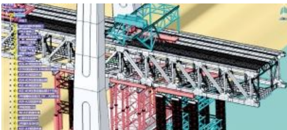
(4)吊机走行前移并安装钢梁提升架
