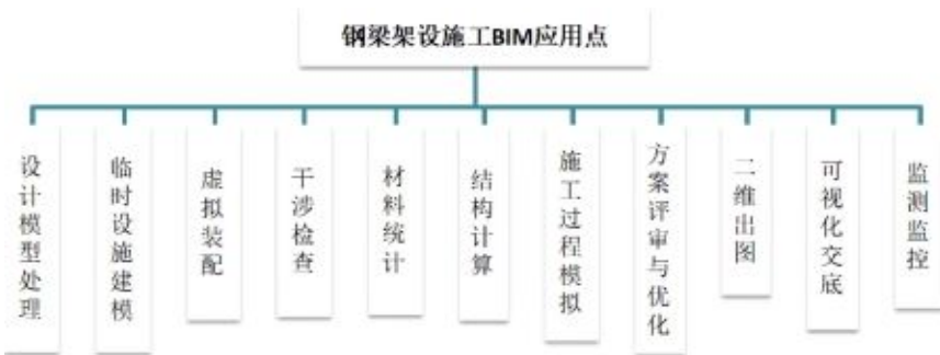
图 5 钢梁架设施工中 BIM 应用点
