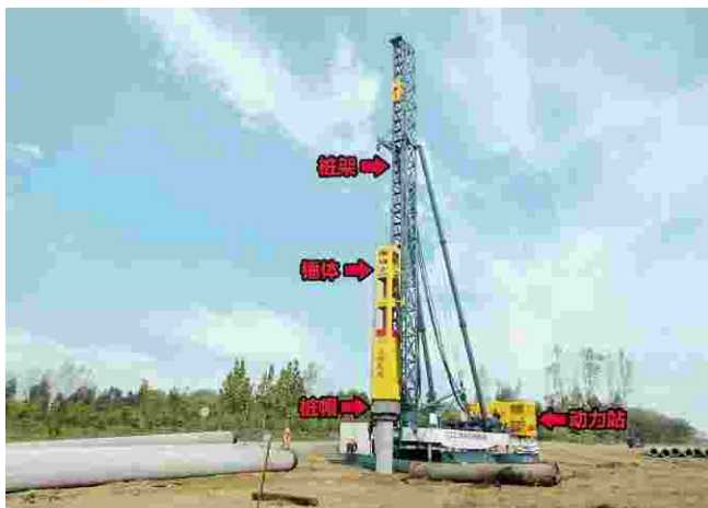
图4 环保液压打桩锤主要部件
