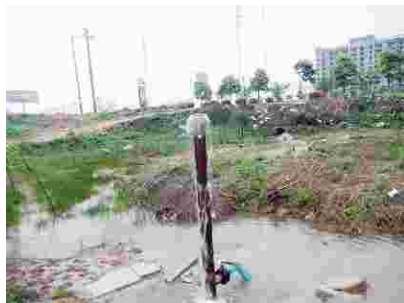
图9 岩溶裂隙水涌水试验
