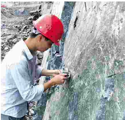
图6 岩层产状测量图
