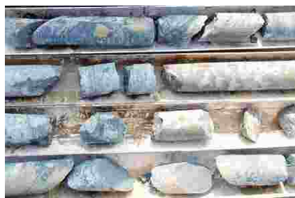
图 5 微风化泥岩芯样
