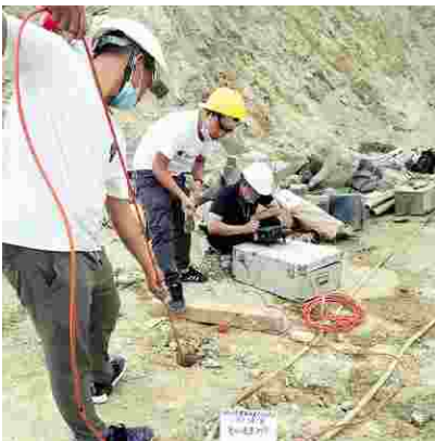
图5 剪切波速测试图
