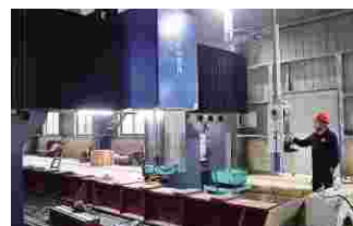
图8 四轴数控龙门铣加工轨道面
