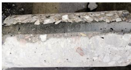
图九 墙体连通腔灌浆密度剖切图
