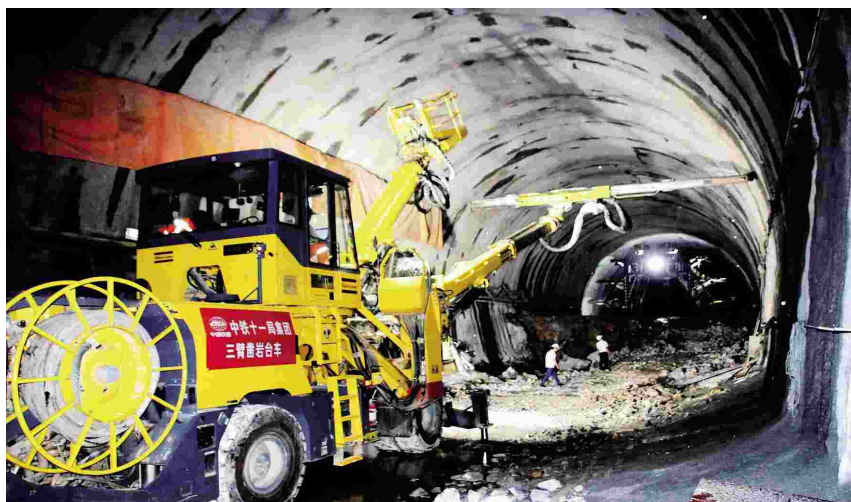
2018年9月27日,全智能三臂凿岩台车在中铁十一局四公司贵南高铁项目部都安隧道进口作业。(郑传海摄)
