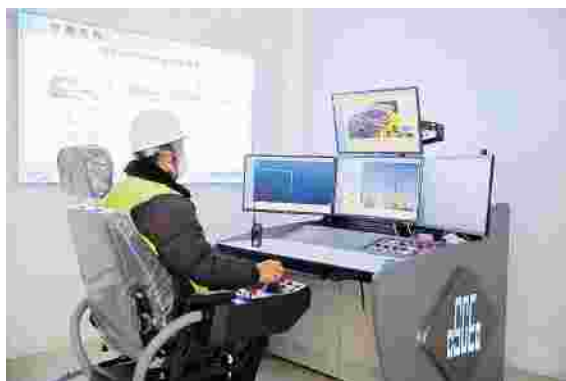
基于施工现场 5G 环境的室内远程智能控制塔机
