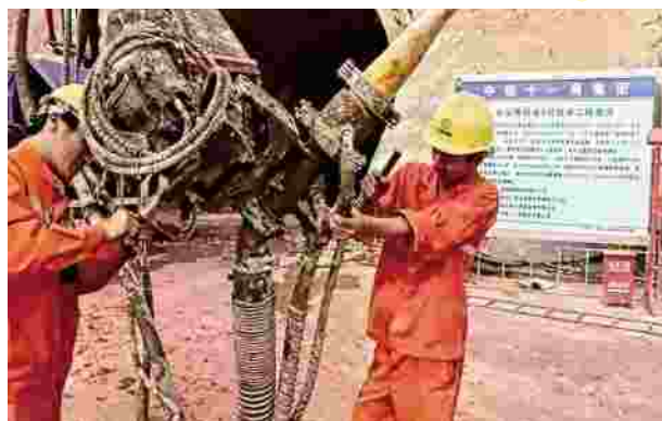
由念保健带领的福建瑞鼎丰建筑公司操作手在中老铁路普洱境内的石头寨隧道口保养湿喷混凝土“机械手”。
