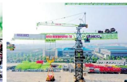
型塔机核心关键技术方面申请专利达78项,是当之无愧的大国重器。塔机具备应力流线分布的高承载轻量化结构构型,移动平衡重、安全与协同施工全景管理智能控制、超大型塔机首次应用大功率永磁同步驱动等最先进的技术,让设备更安全、智能、高效、绿色。
