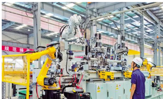
2021年8月31日,中国铁建电气化局京津冀智能预配中心,京唐城际铁路项目员工正在仔细观察第3代智能腕臂预配平台腕臂预配作业情况。(宋建卿摄)
