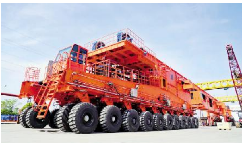
TJ-YT1000/40 运架一体机“昆仑号”首次完成组装,在汉江重工厂区内进行调试
