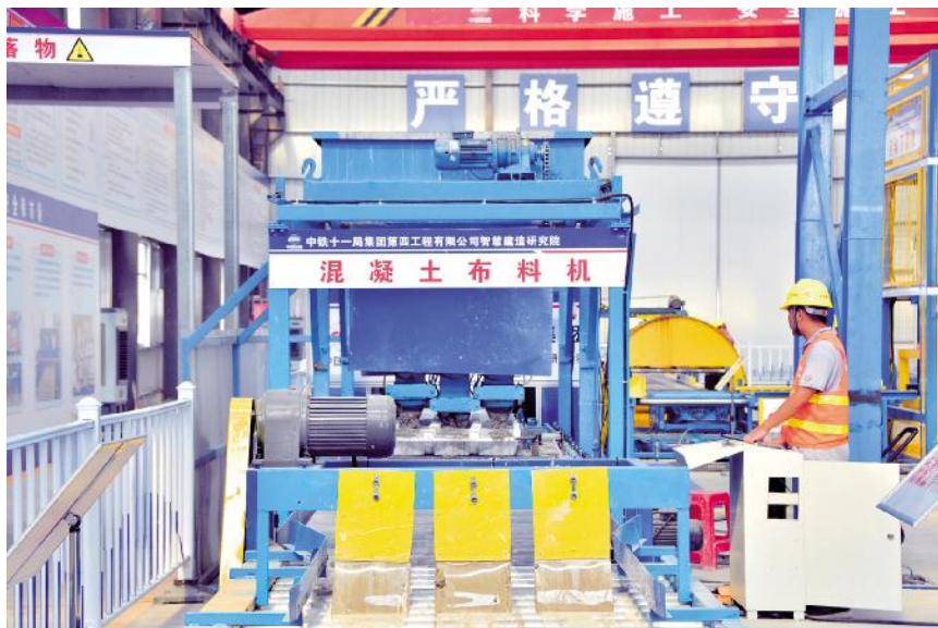
2023年8月17日，中铁十一局四公司智慧建造研究院研发的混凝土布料机，正在京港澳高速公路湖北孝感境内的改扩建项目进行混凝土布料作业。(李立伟 摄)
