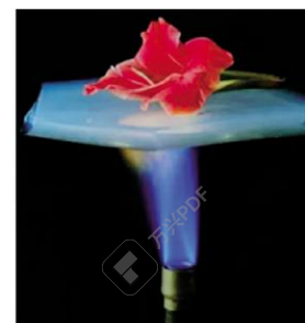
气凝胶材料、微观结构及保温效果(自绘)
