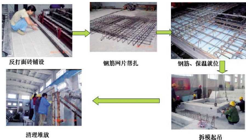
图3.9 PC构件生产过程
