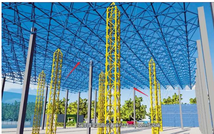
图 4.4.2-1 顶升架增设缆风绳示意图
