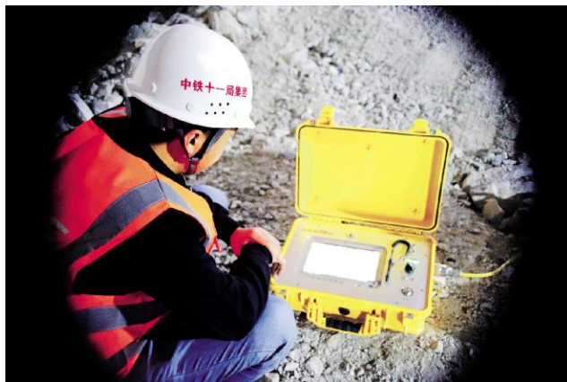
2018年12月12日, 中铁十一局四公司贵南项目部超前地质预报中心员工, 在二级风险隧道都安隧道通过 TSP 仪器监测隧道两侧的地质情况。 (郑传海摄)
