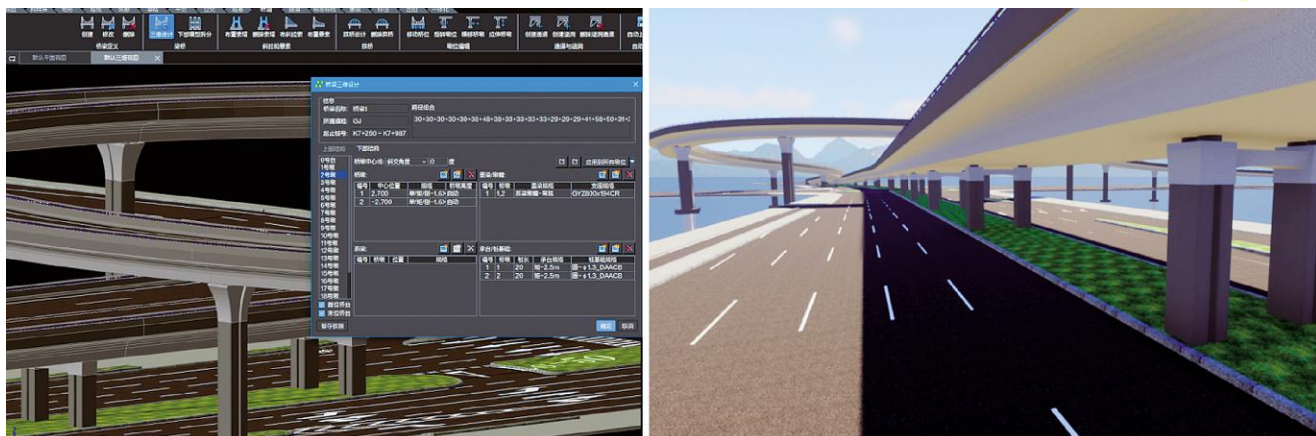
图3 “桥梁三维设计”功能面板及渲染效果
